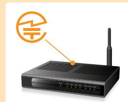
無線LAN 据え置き型の機器：裏面
