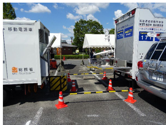
【当局の移動電源車からNTT西日本の衛星通信移動無線車に電源を供給】
