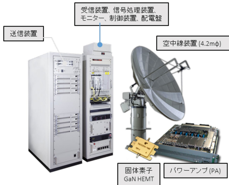
図 1. 3-5 固体化 MP レーダーシステムの外観
