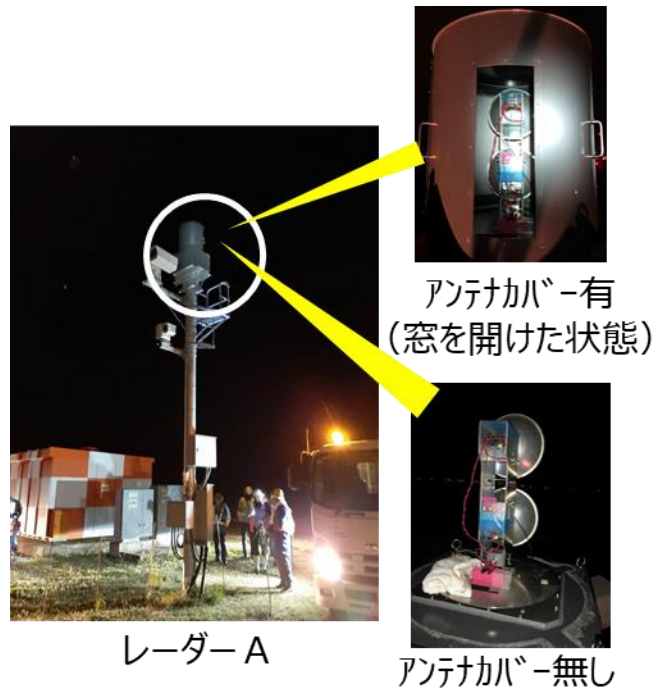
図 7 レーダー設置状況と測定条件
