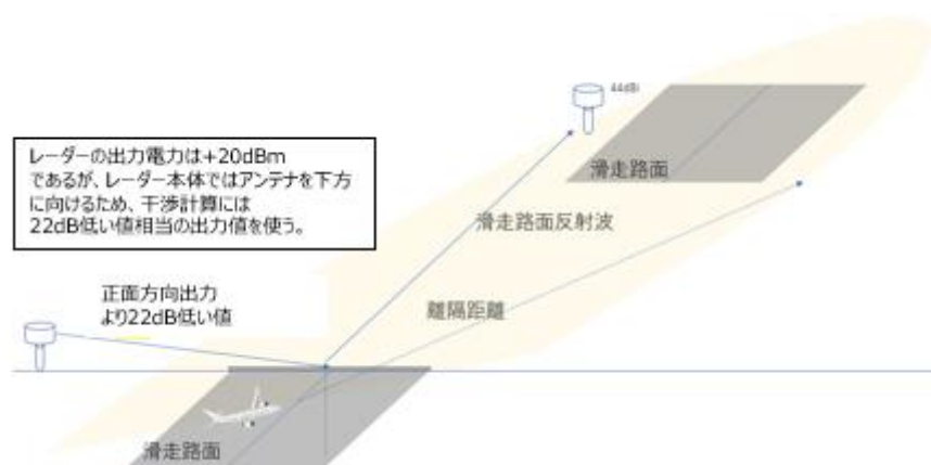
図 55 空港 FOD レーダー同士の干渉モデル
