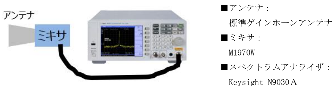
図 6 漏洩電力測定設備
