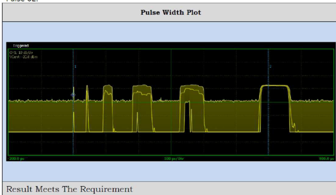
図 3.1-1 複数の PON 電波及び QON 電波を送信する例（出典：FCC レポートより）
