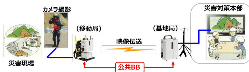
図12：公共ブロードバンド移動通信システムの利用イメージ
