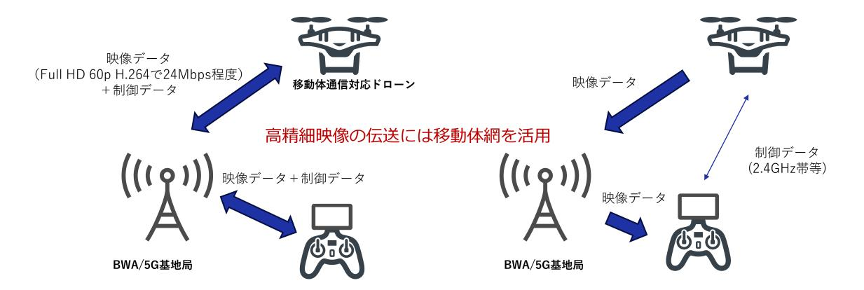
Level3以上の飛行では制御データもモバイル網での接続が必要
