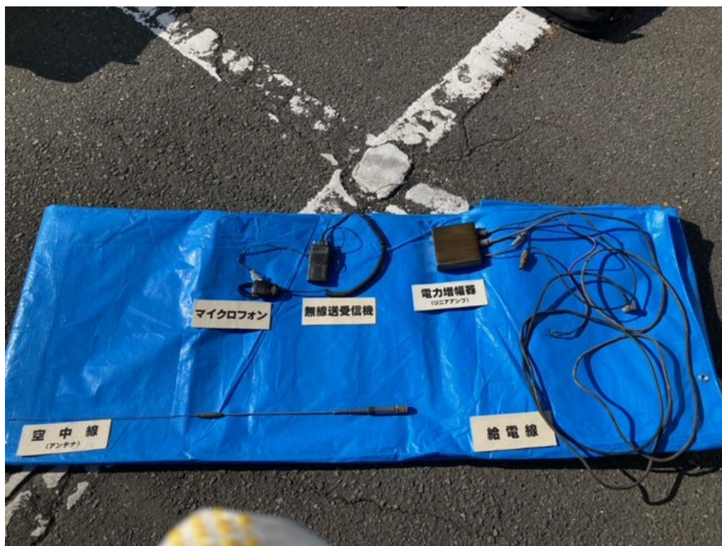
写真 2 : 設置されていた無線設備
