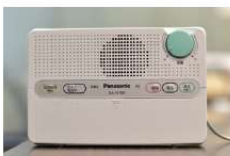
▲1世帯に1台ずつ無料貸し出しされている戸別受信機。災害時はサイレンや音声放送が鳴り、市役所から発信される災害情報も早く入手できる
