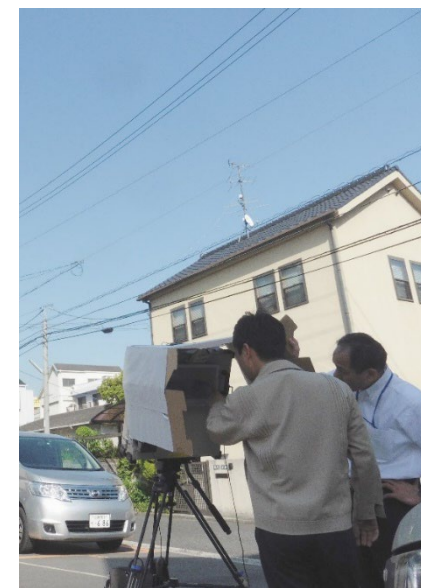
申告に基づく混信源探査 (電波発射源可視化装置使用)
