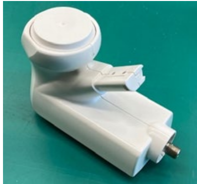
図4. 2-5 ②BPF追加による対策モデル 試作品
