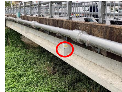
橋に取り付けたIoT水位計
