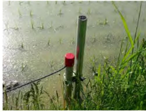
水位水温計測の自動化
