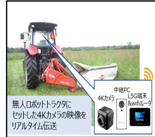
ロボットトラクタへの搭載機器
