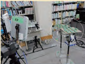
2ゾーン構成による20ch同時通信を実現 (ただし無線端末は電池駆動)
