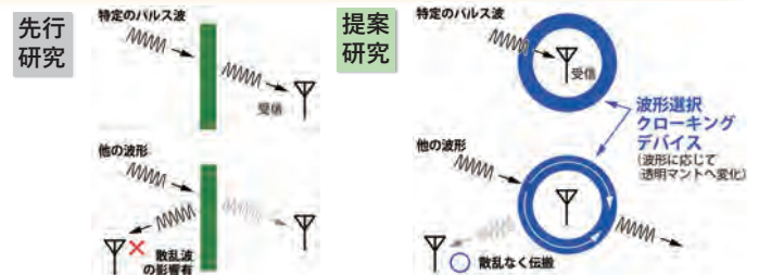
図2. 本研究の狙い. クロッキング技術の導入によりパルス幅に応じて電波の伝搬方向を制御.
