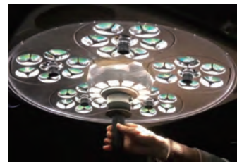
図2 マルチカメラ搭載型无影灯 (Kajita, et al. PRSGO 2020)
