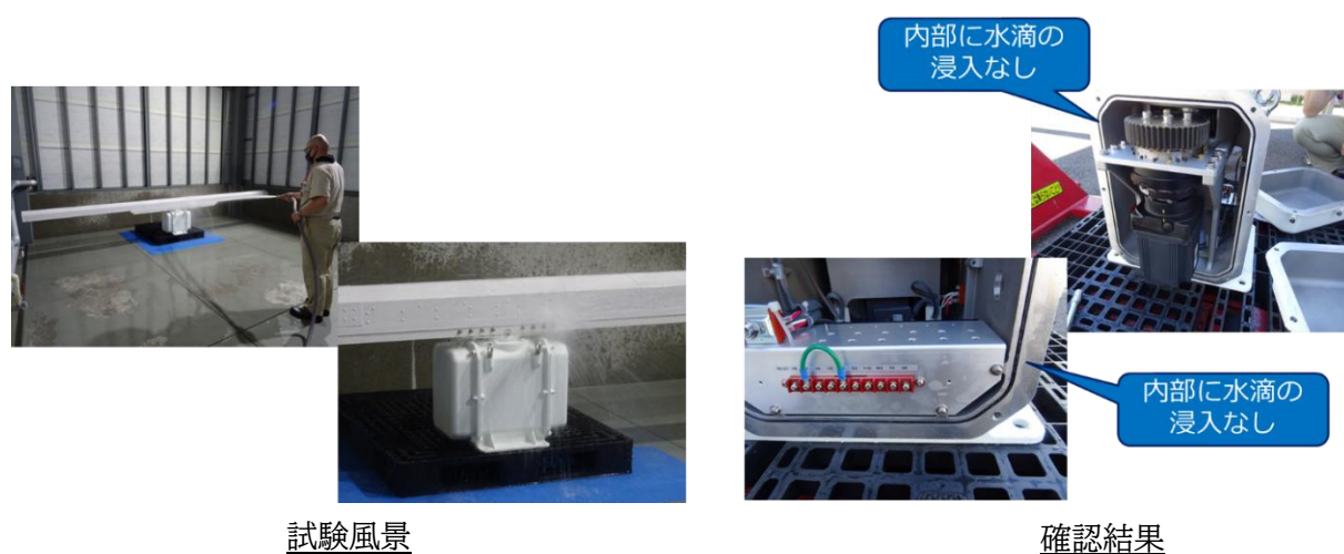
図 3-2 防水試験の様子
