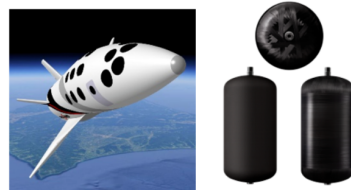
図：サブオービタルスペースプレーンの機体イメージ(左)と複合材タンクの外観(右)
