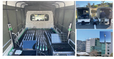
1000台での通信性能 (屋外実験@YRP)
