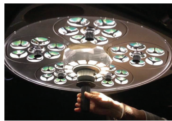
図2 マルチカメラ搭載型无影灯 (Kajita, et al. PRSGO 2020)
