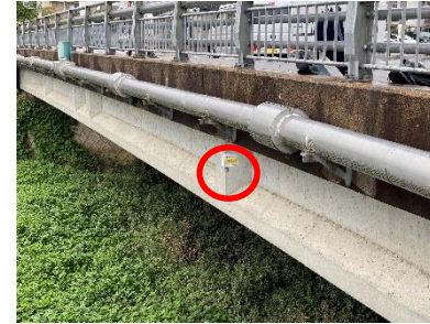
橋に取り付けたIoT水位計
