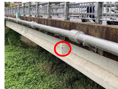
橋に取り付けたIoT水位計
