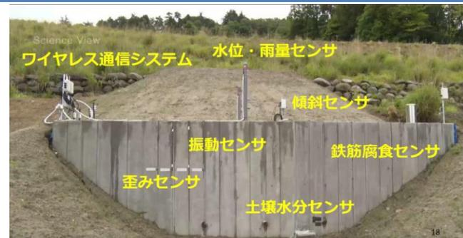
2022年に地盤センシングプロジェクトに関する共同研究契約を締結し、従来にはない様々な環境に柔軟に対応できるレジリエンスデバイスを創出するための研究を進めている。豊能町の実証フィールドとして、様々なシート型センサを配置した実験用擁壁を設置し、現在、土壌と擁壁にかかる力を常時モニタリングしている。テクノロジーの開発だけでなく、地域住民の方を中心とした「産学官民」の連携による地域づくりを目指して取り組んでいる。
