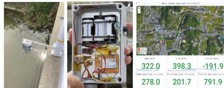
地産地消によるIoTを利用した、簡易で安価な水位計システムを地元の自主防災組織と共に設置。河川情報の「見える化」を進め、住民がいつでも自宅で確認できるモニタリング体制を構築。
