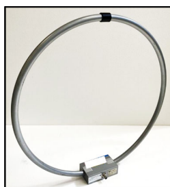
図 3 シールドドロープアンテナの例
