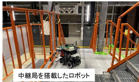
中継局を搭載したロボット
