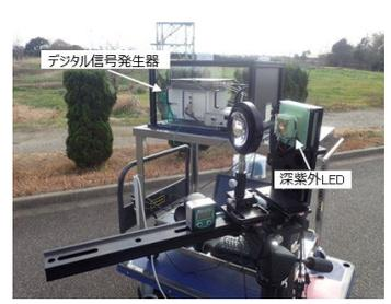
日中・屋外“見通し外”(NLOS)環境下での深紫外LEDを活用した光無線通信の実験配置図
