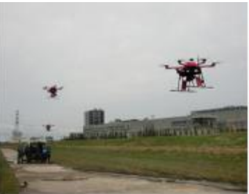
大規模ドローン管制システムによる 最大37機同時制御
