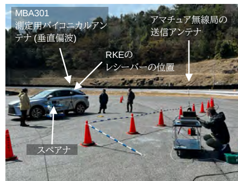
アマチュア無線局からRKEへの干渉試験
