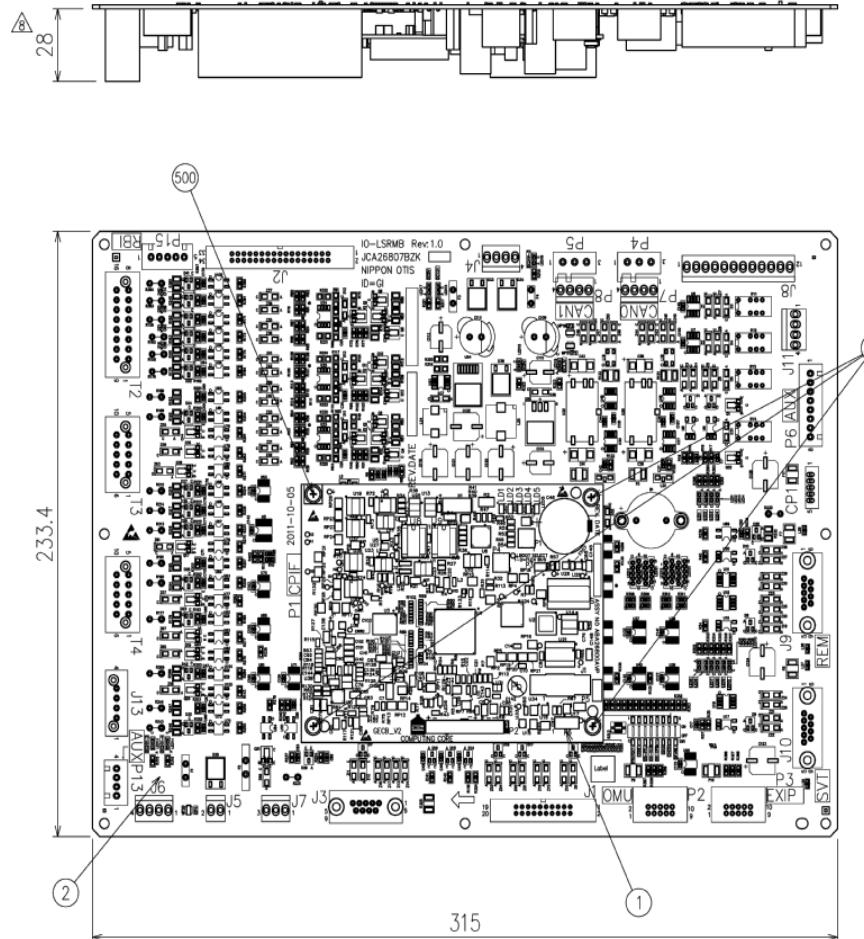
NOTE1 : TIGHTENING TORQUE FOR SCREWS 0.2–0.29Nm.
