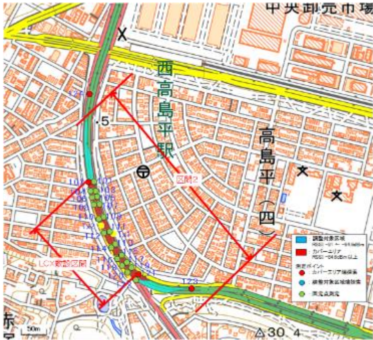
図 3-55 区間②漏洩同軸ケーブル適用時の高速道路上の測定点
