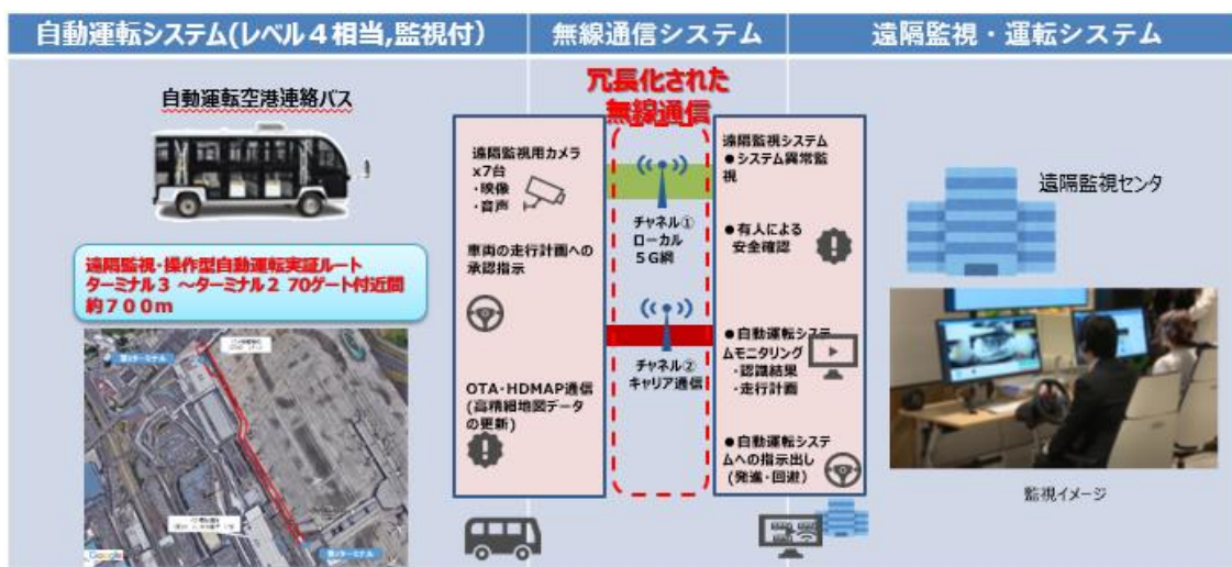
図 1-3 遠隔監視要件を満たす冗長通信の実現
