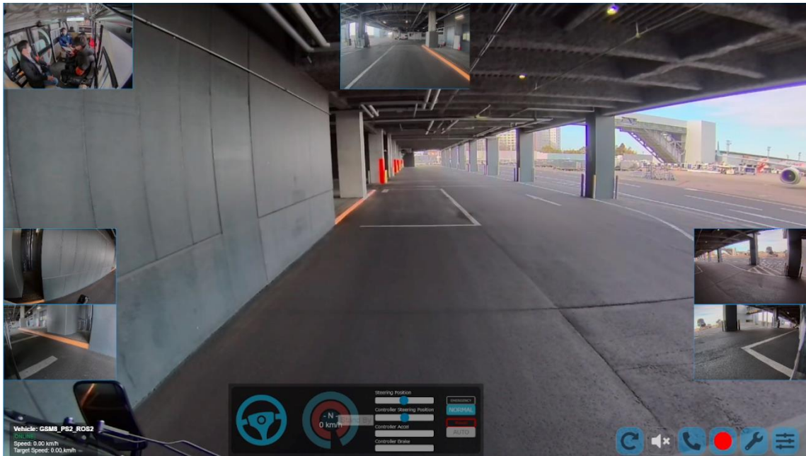
図 4-42 遠隔監視システムの映像確認画(計測地点 1)
