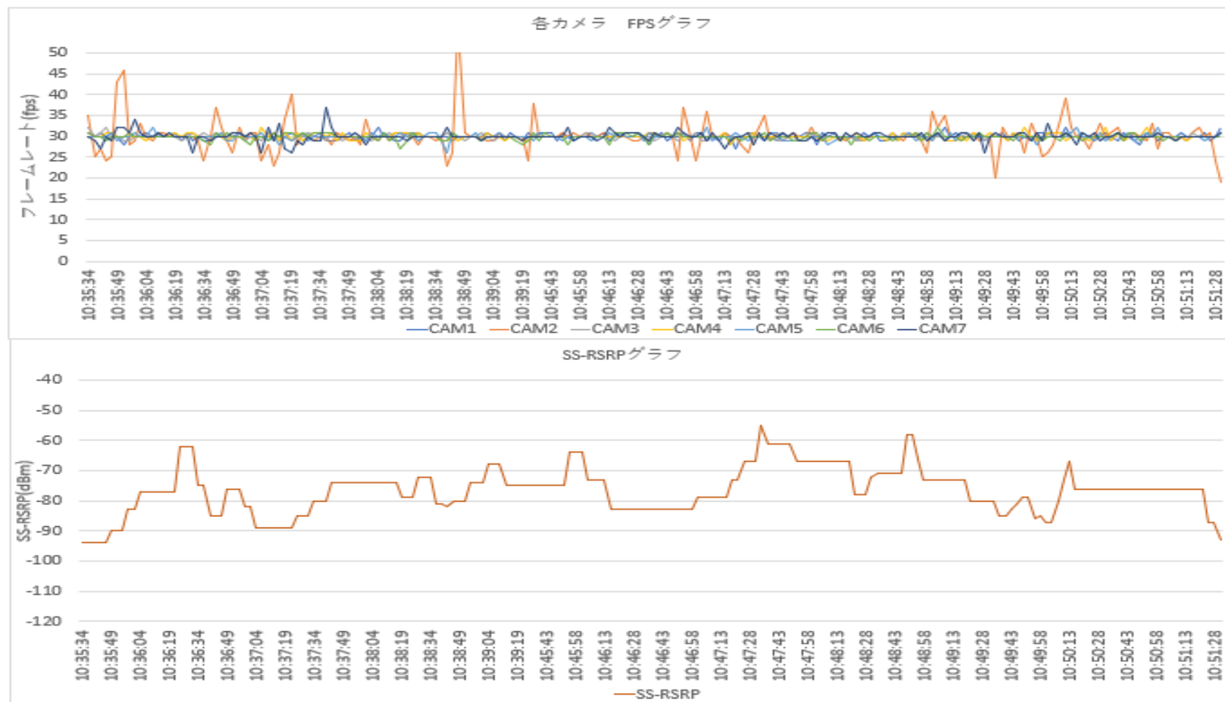
図 4-54 各カメラのフレームレートおよび SS-RSRP のグラフ
