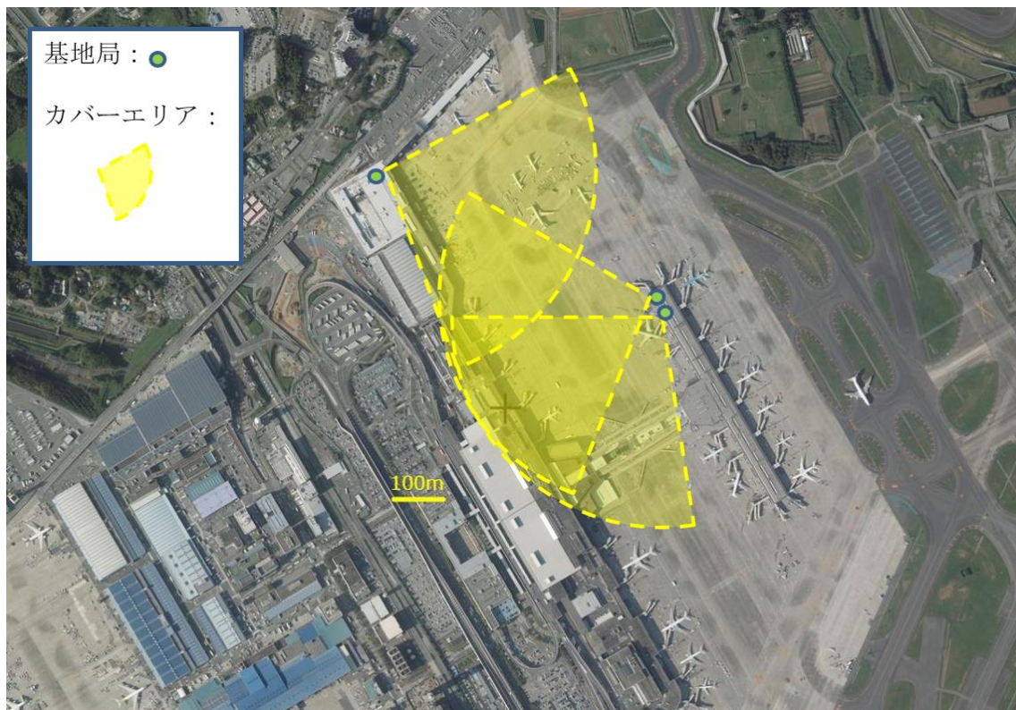
図 3-37 (変更前) 基地局設置位置およびカバーエリアイメージ図
