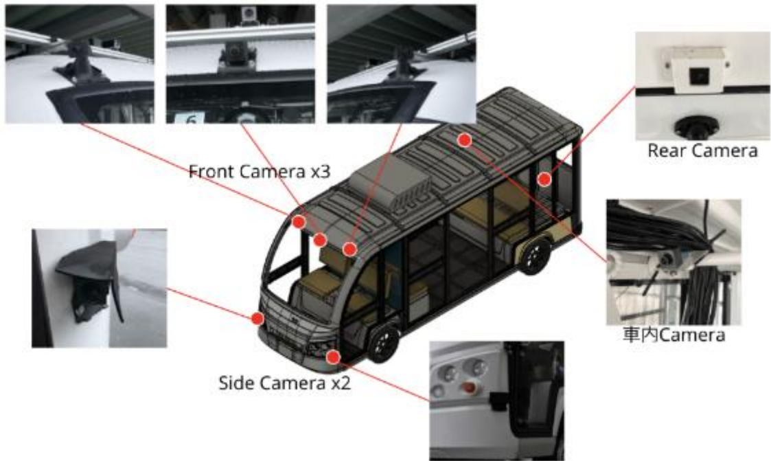
図 4-12 遠隔監視用カメラ搭載位置イメージ
