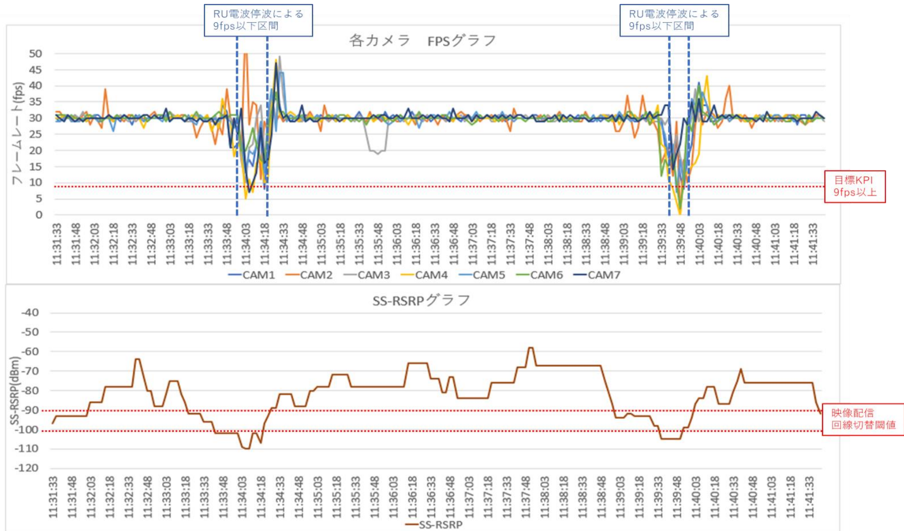
図 4-241 走行中における失陥模擬の確認
