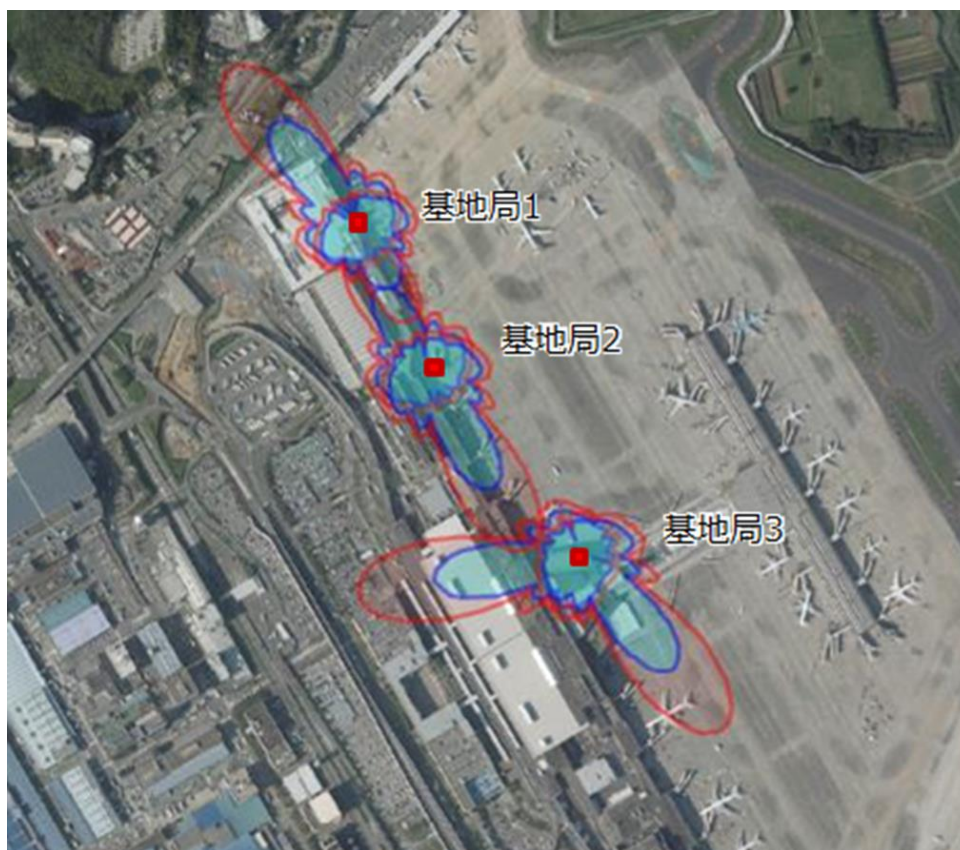
図 3-42 パラメータ修正前のエリア算出法によるカバーエリア及び調整対象区域図
