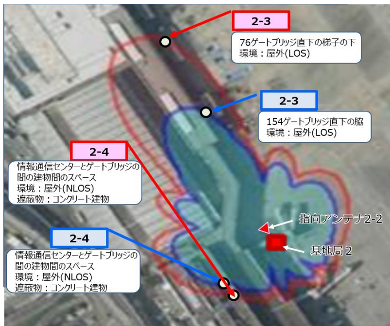
図 3-6 エプロンエリア エリア算出法より算出したカバーエリア及び調整対象区域と測定ポイント (Site2-2)
