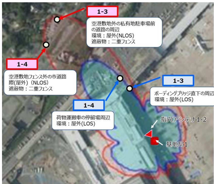
図 3-4 エプロンエリア エリア算出法より算出したカバーエリア及び調整対象区域と測定ポイント (Site1-2)
