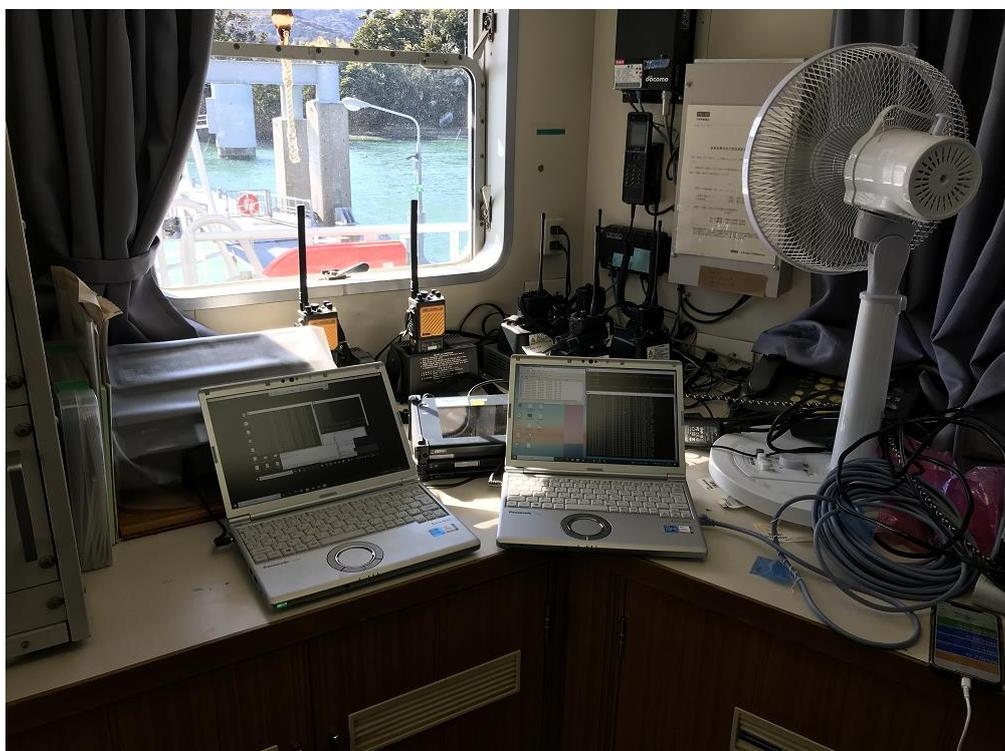
図 3.3.1.3-23 スループット測定及び伝送遅延測定用機器の設置状態
