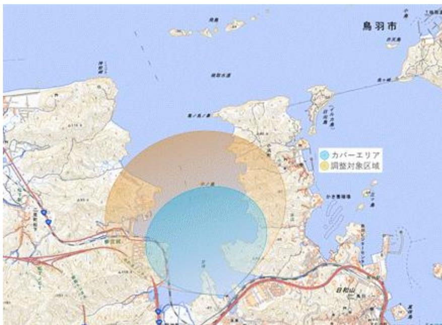
図 3.2-1 審査基準に基づくカバーエリア及び調整対象区域（艇庫基地局）
