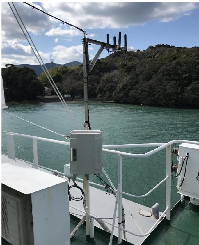
図 3.3.1.3-21 スループット測定及び伝送遅延測定用のアンテナ設置状況
