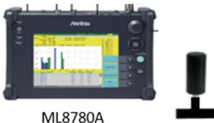
図 3.3.1.3-7 受信電力測定機材 (エリアテスト ML8780A、アンテナ Z-1911B)
