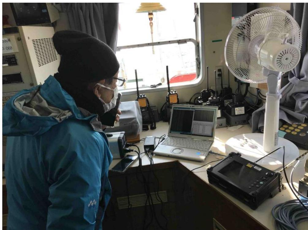
図 3.3.1.3-24 スループット測定と伝送遅延測定の測定状況
