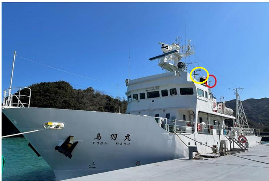
図 3.3.1.3-20 スループット測定及び伝送遅延測定用のアンテナ設置場所 (黄色丸箇所)
