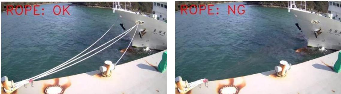
図 4.4.1.2-17 実画像と合成画像に対してロープテンションの異常検知を実行した結果
