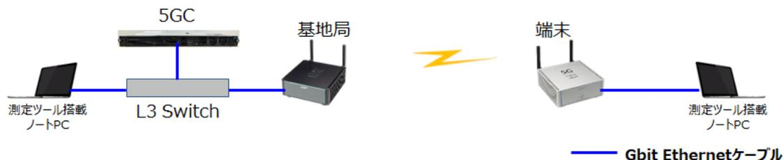
図 6.3.3-1 評価・検証システム構成
