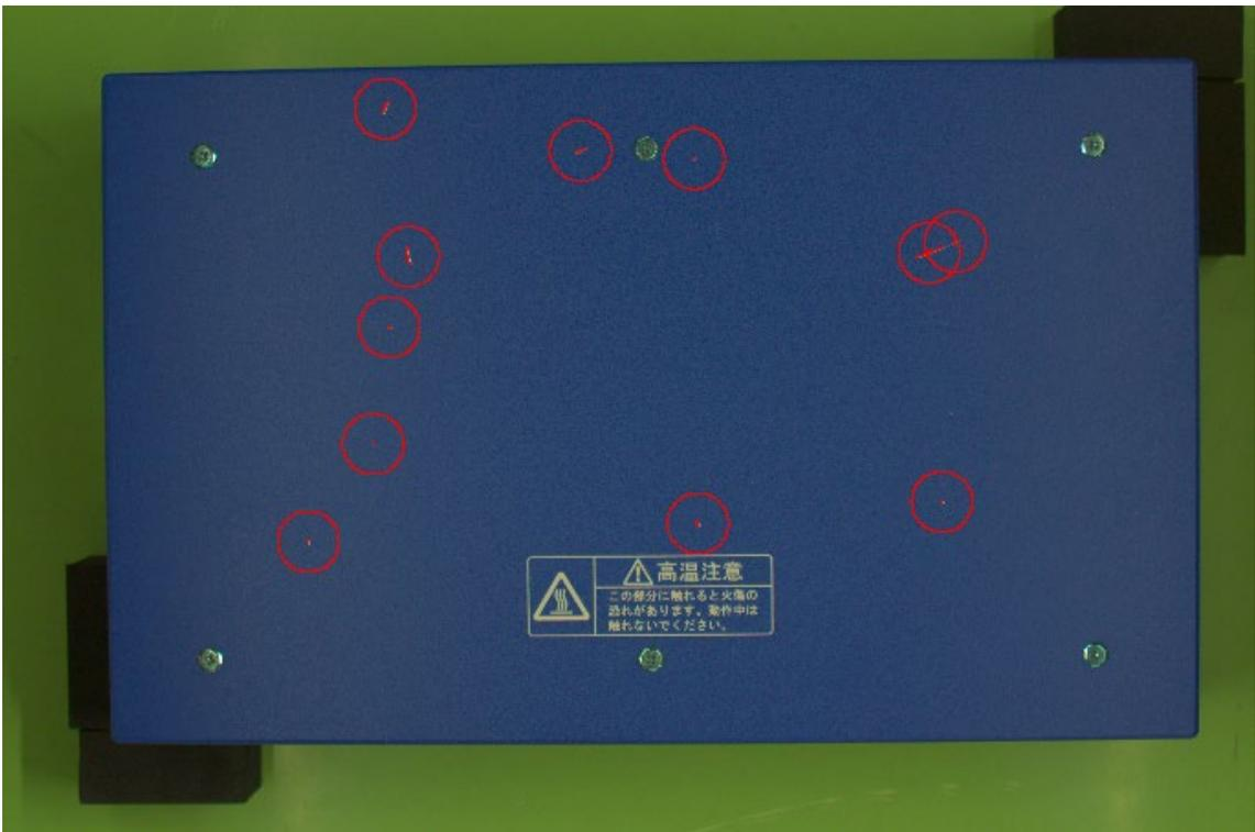
図 4.5.5-2 トップカバーの傷検知 (4104×2736)
