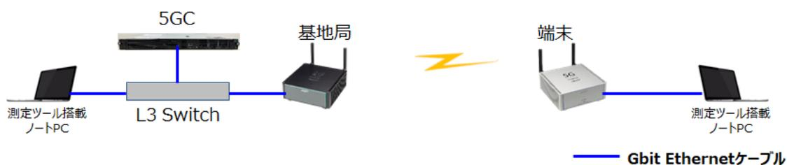
図 6.1.2-1 NW・システム構成
