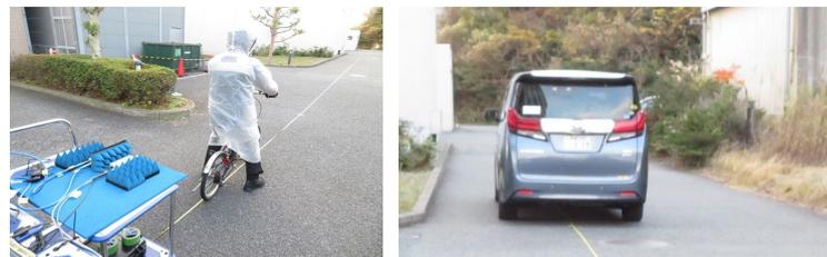
図 12：降雨の影響を考慮した電波反射測定（対象物に散水した状況で測定）
