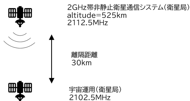
図2.4.2-1 2GHz帯非静止衛星通信システム(衛星局)から宇宙運用システム(衛星局)への与干渉への1対1対向モデル
