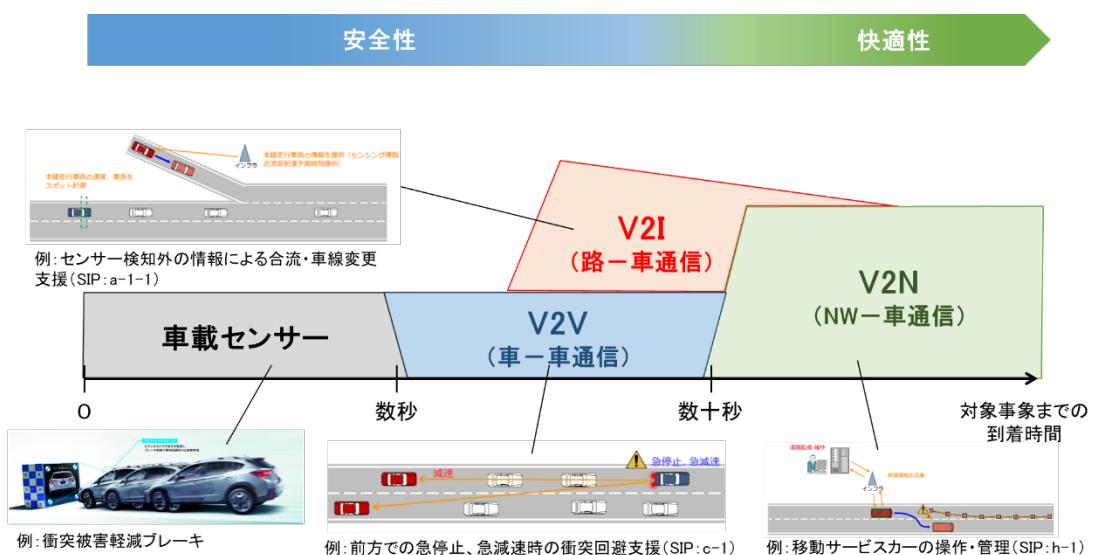
図13 V2X (V2I、V2V) 通信、V2N 通信の役割分担・連携イメージ
