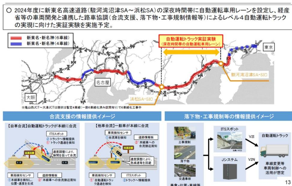
図7 新東名高速道路における自動運転トラック実証実験概要<sup>10</sup>
