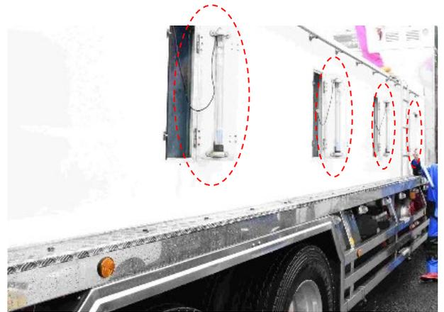
【不要電波を発生させていた活魚車の水槽照明用のLED設備】
