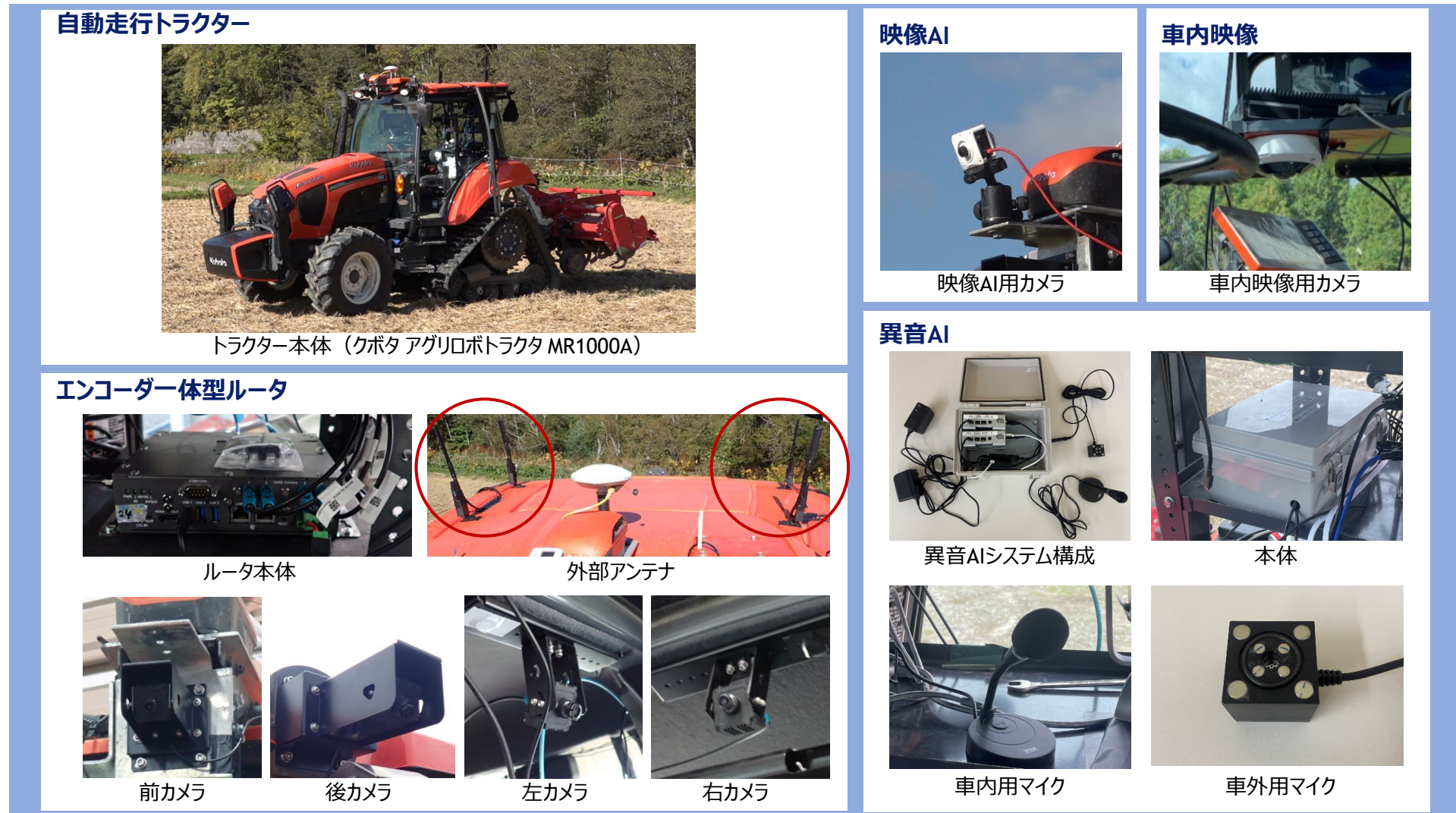
図 IV.7-12 自動走行トラクター機器構成概要
