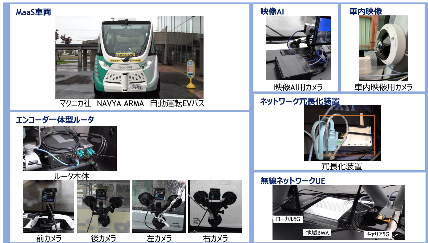
図 IV.7-21 MaaS車両機器構成概要
