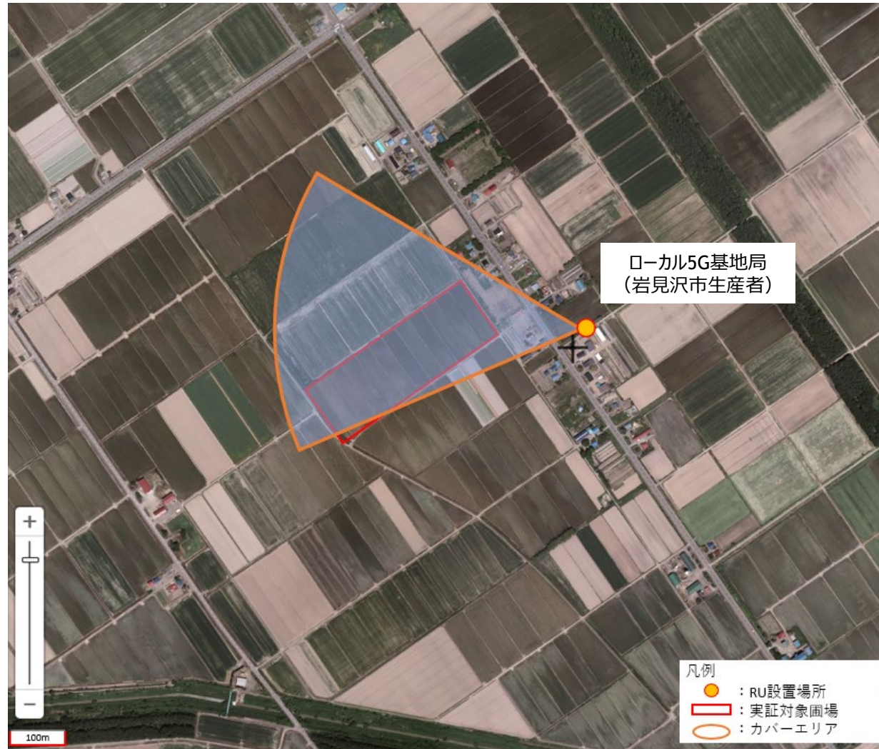
図 Ⅲ.2-3 基地局設置場所・対象圃場・カバーエリア (指向性アンテナ)
