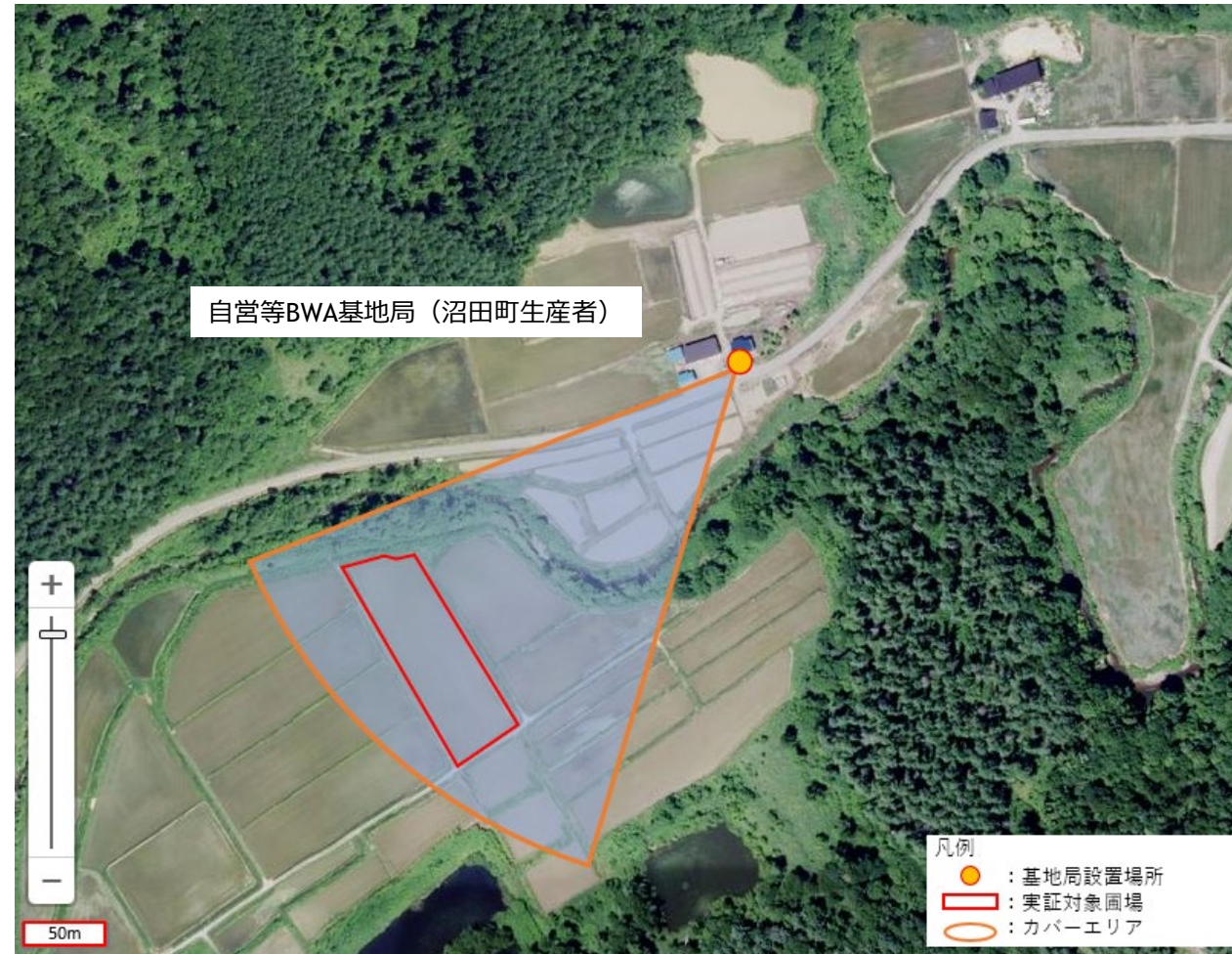
図 Ⅲ.2-6 基地局設置場所・カバーエリア・実証対象は場 (指向性アンテナ)
