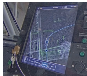
図 IV.7-26 MaaS車内映像（遠隔監視ソリューション、LiDAR検知状況）
