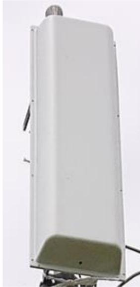
図2-2 外部セクターアンテナ外観
