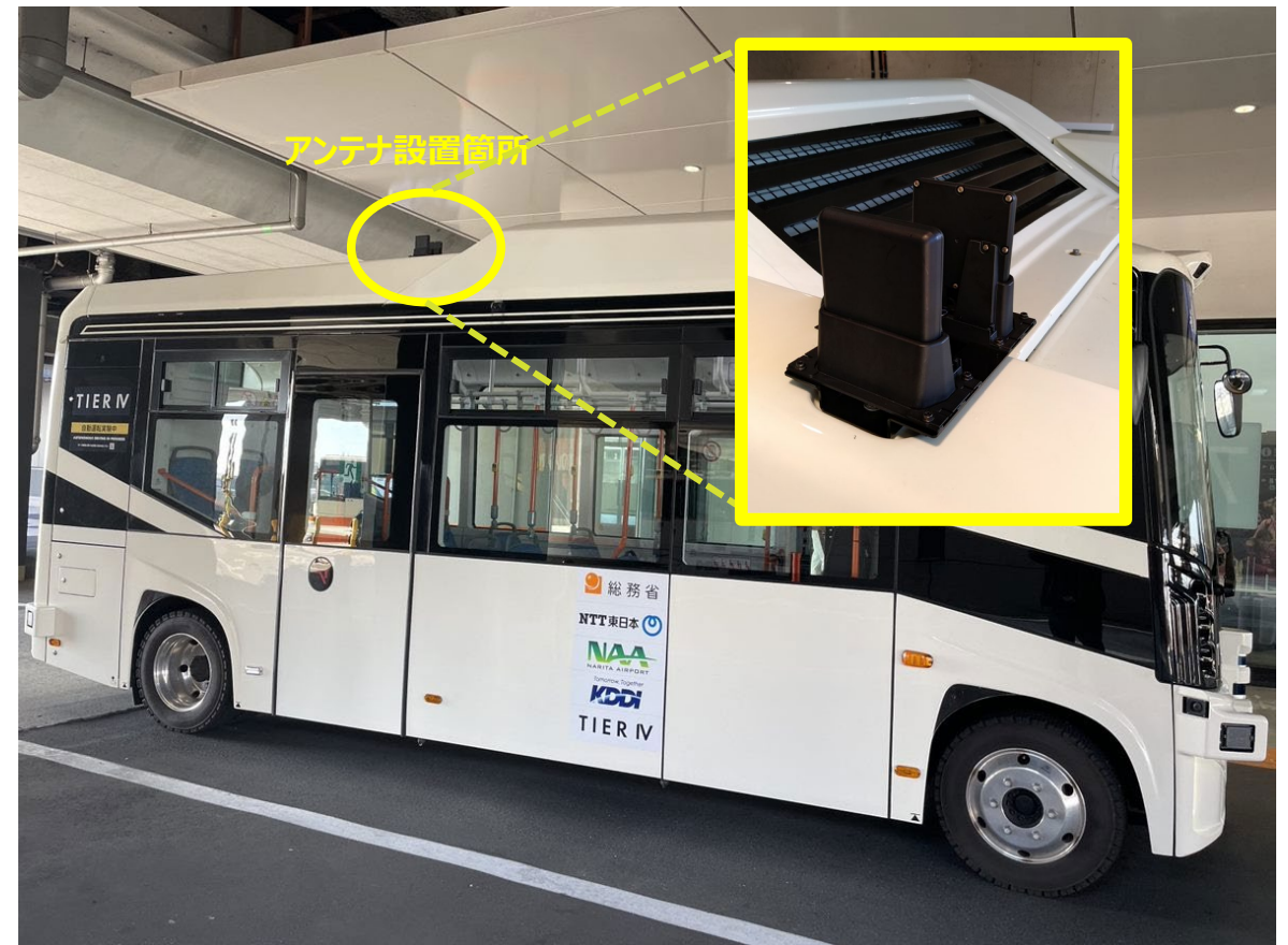
自動運転車両へのローカル 5 G・キャリア 5 G 端末用アンテナ設置イメージ
