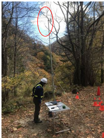
親機設置状況
