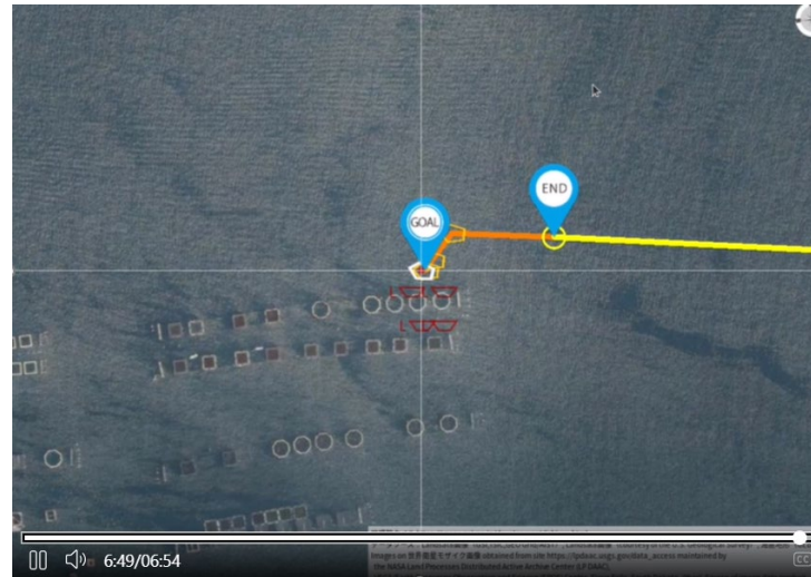
LiDARが検知した障害物を赤い船マークで表示
