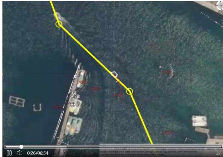
LiDARが検知した障害物を赤い船マークで表示
