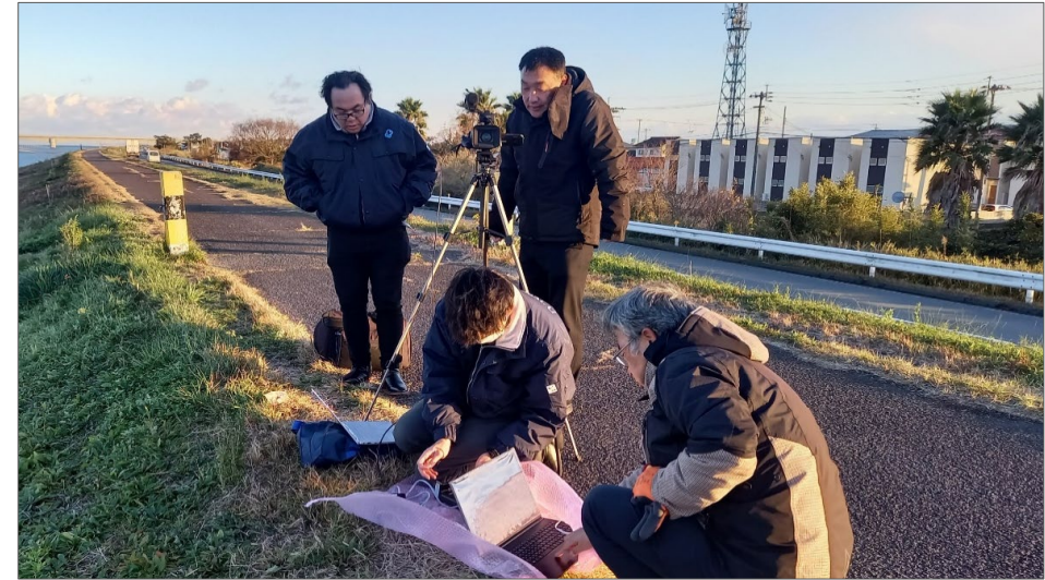
吉野川右岸堤防での接続実験（見通し距離約150m）
