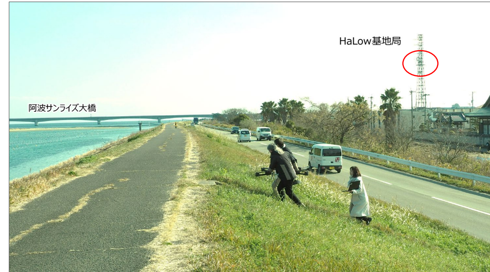
吉野川右岸の土手（高さ約6m）は、基地局とは見通し距離
