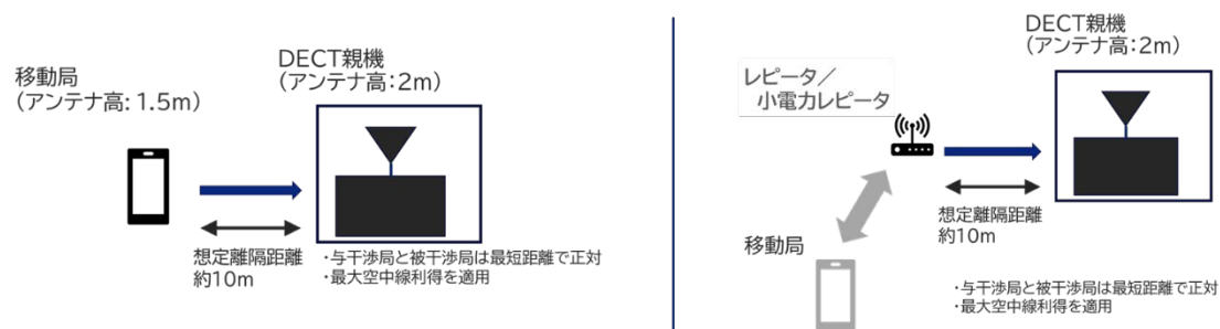
図 2. 6. 2-2 2GHz 帯非静止衛星通信システム（移動局）から デジタルコードレス電話システム（DECT 方式親機）への与干渉の 1 対 1 対向モデル
