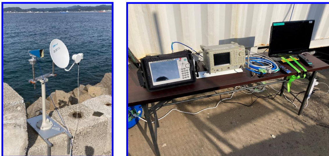
図 3-35 CS衛星放送との干渉試験の様子
