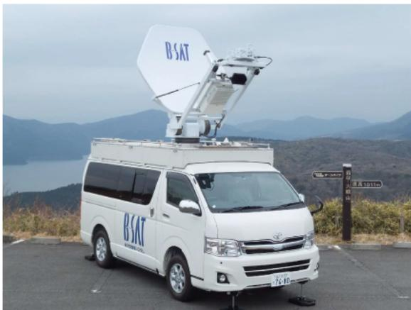
地デジ受信機、CS受信機、映像・音声入力を備え、MPEG-2エンコーダー、TS多重化装置、TS合成装置を搭載して17GHz750W送信機から1.5mアンテナで送信する能力がある。
