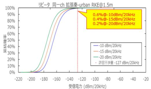
参图 4-27 RKE からアマチュア局（移動・車載/ハンディ（左）、固定・レピータ（ホイップ）（右））への干渉発生確率（同一帯域利用、普及予測パターン 2）
