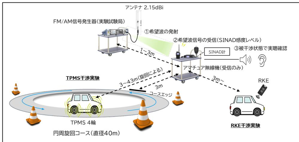
図 3. 2. 3-1 実機試験で用いた試験系
