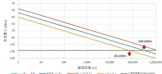
参图2-2 自由空間損失のみ Itx E.I.R.P.: -10dBm
