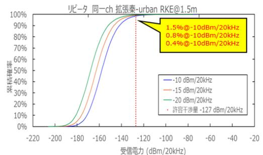
参图 4-28 RKE からアマチュア局（固定・レピータ（コリニアアンテナ））への干渉発生確率（同一帯域利用、普及予測パターン 1（左）、普及予測パターン 2（右））
