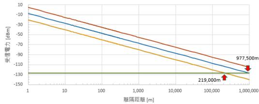
参图2-1 自由空間損失のみ Itx E.I.R.P.: 0dBm
