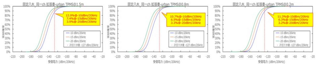
参図 4-6 TPMS からアマチュア局（固定・八木）への干渉発生確率
