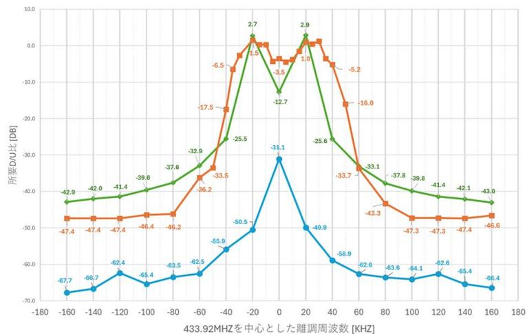
参図 5-5 3 方式における測定結果の比較
