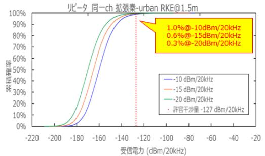
参图 4-26 RKE からアマチュア局（移動・車載/ハンディ（左）、固定・レピータ（ホイップ）（右））への干渉発生確率（同一帯域利用、普及予測パターン 1）
