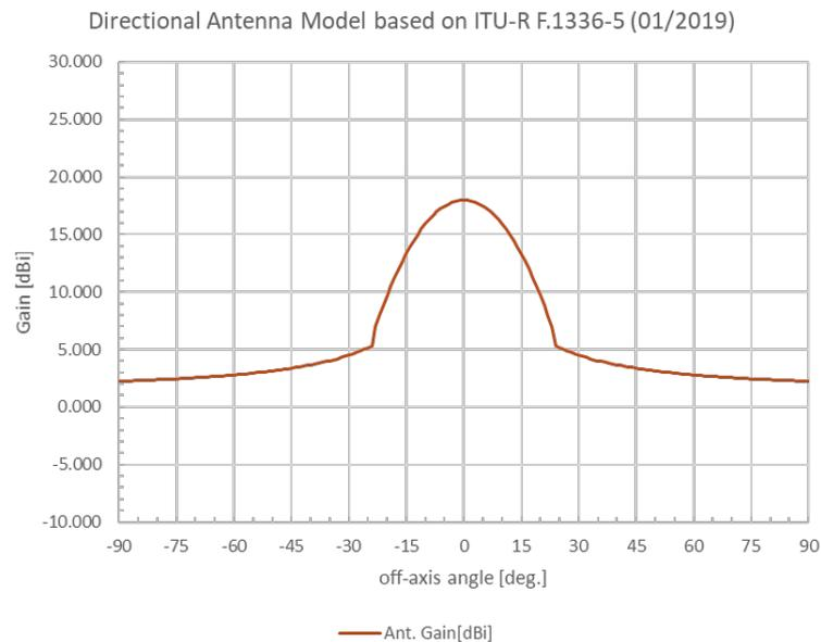
参図 2-36 八木アンテナのアンテナモデル (15 エレ)
