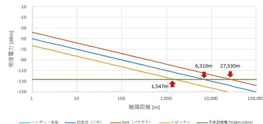
参图2-3 自由空間損失のみ Itx 帯域外 -36.02dBm/100kHz (-43.01dBm/20kHz)
