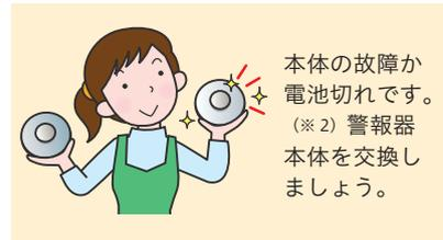
※1 住宅用火災警報器の電池の寿命の目安は約10年とされています。警報器の作動確認は、春秋の火災予防運動の時期に行うなど、定期的を実施してください。
