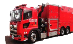
【海水利用型消防水利システム】
