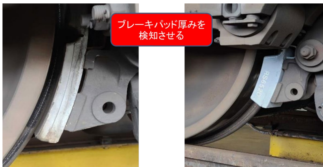
図 4. 4. 3. 1-19 ブレーキパッド異常模擬セッティング
