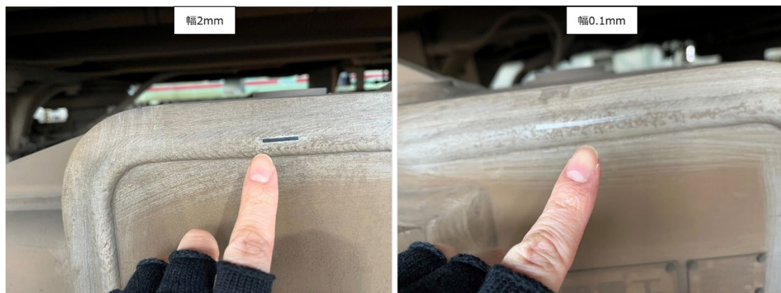
図 4. 4. 3. 1-17 疑似クラック水平貼り付け
