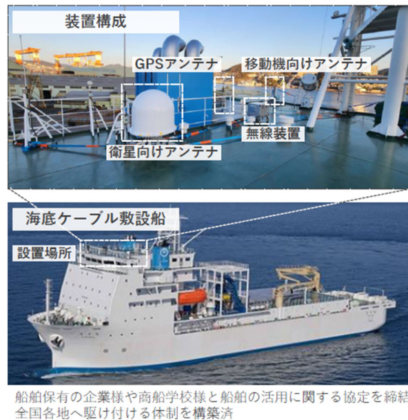
図 10 NTT ドコモの取組例（船舶基地局）
