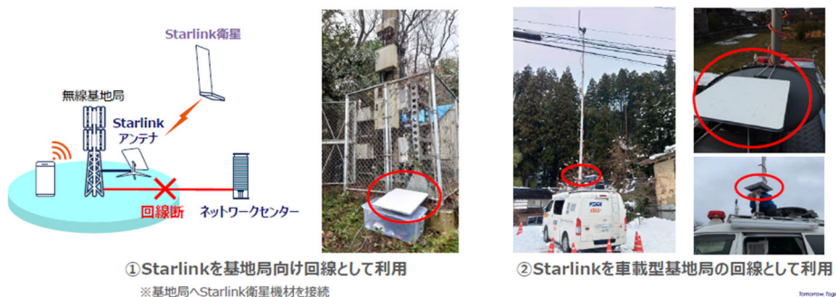
図 11 KDDI の取組例（非静止衛星を利用した衛星エントランス回線）
