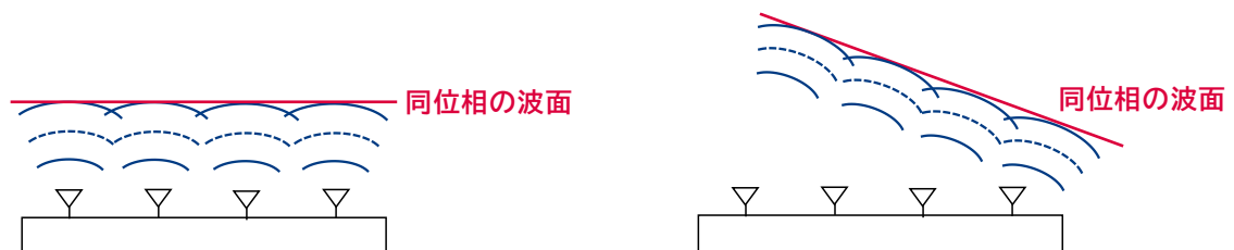
図 2-1 電子的な走査方法のイメージ
